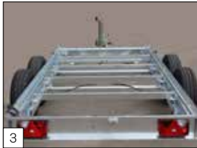
3 Standaard: gelast en volbad verzinkt onderstel voor tandemasser.
