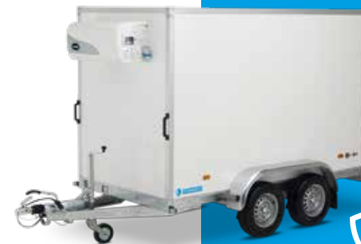
12 Standaard: wanden met gelcoat, dak en vloer 400 mm geïsoleerd.
