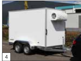
4 Optie: dubbelassige koelwagens tot 3500 kg bruto laadvermogen, afmeting tot en met maximaal 400 x 180 x 210 cm.
