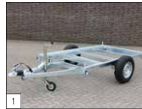
1 Standaard: gelast en volbad verzinkt onderstel voor enkelasser.
