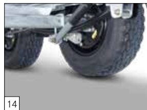
Optie: De Azure H-modellen in 3500 kg, vanaf 335 x 180 cm kunnen uitgevoerd worden met paraboolvering incl. schokbrekers. Bij banden 185/70 R13 C of 195/50 R13 zijn tevens zwarte velgen gemonteerd.
