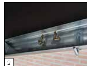
Optie: boutbare haken aan de binnenzijde van de zijrand voor het eenvoudig vastzetten van bijvoorbeeld een ladingnet.
