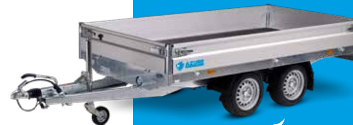
Optie: in hoogte verstelbare dissel, gemonteerd met kogelkoppeling of oog. De dissel is voorzien van een versterkt steunwiel.
