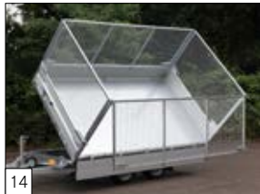
Optie: afneembaar gaasrekwerk 100 cm hoog voor de modellen 305 x 180 en 335 x 180 cm.
