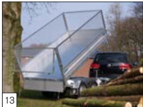
Optie: afneembaar gaasrekwerk 70 cm hoog en gaasrekken vanaf 335 cm, versterkt met zijstaanders.
