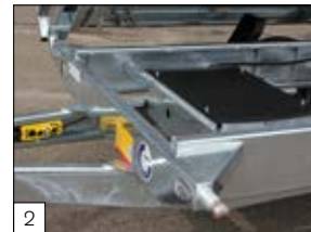
Standaard: elektrische bediening met accu in stalen beschermbak met kunststof afdekkap.
