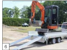
Optie: 'Oprij'-pakket: 2 aluminium oprijbalken geïntegreerd onder de vloer en 2 stabiele verstelbare uitzetpoten incl. slinger.
