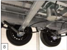
Optie: paraboolvering incl. schokbrekers op de assen.
