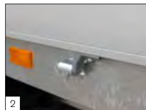
2 Standaard: rondom scharnierpunten aangebrachte haak voor eenvoudige montage van o.a. ladingnet.
