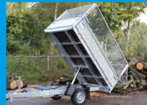
2 Standaard: rondom scharnierpunten aangebrachte haak voor eenvoudige montage van o.a. ladingnet.
