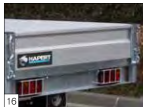
16 Optie: achterlicht afscherming, voorzien van scharnierend achterbord boven en onder (alleen mogelijk i.c.m. borden 400 mm hoog).
