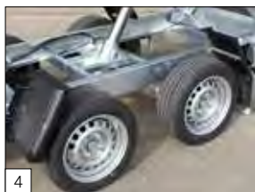
4 Standaard: een verlaagd onderstel met banden 195/50 R13.
