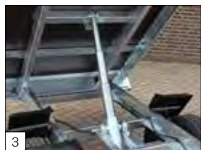
3 Standaard: voorzien van degelijke drietrapscilinder.
