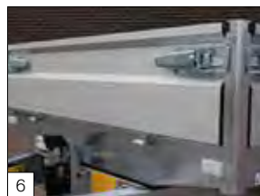
6 Standaard: met 4 degelijke hoekrongen en een scharnierend voorbord.
