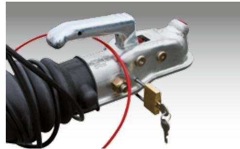
Bügelverschluss für alle gebremsten Anhänger bis 3500 kg
